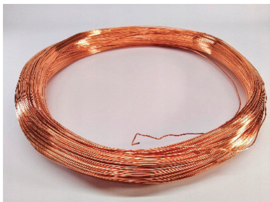
Рис. 2. Медный провод с наноструктурой, характеризующийся повышенной прочностью, термостойкостью и электропроводностью
